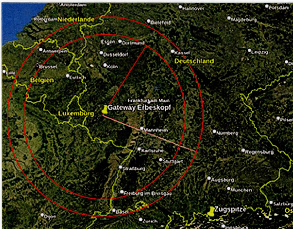
Basisstation Gateway Erbeskopf, RLP, mit zwei kürzlich erfolgten Testwerten: 210 km und 260 km Radius (äußerer roter Kreis).
