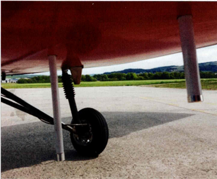
Antennen unter dem Test-Flugzeug, eine C42: vordere Antenne LoRaWAN, hintere Antenne fürs LTE,
